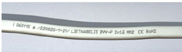
1 pav. Ant AB „Liekabelis“ kabelio BVV-P 3x1,5 mm 2 pateiktas metrus žymintis užrašas „060115“, naudojamas kabelio ilgiui apskaičiuoti Šaltinis: sudaryta autorių
