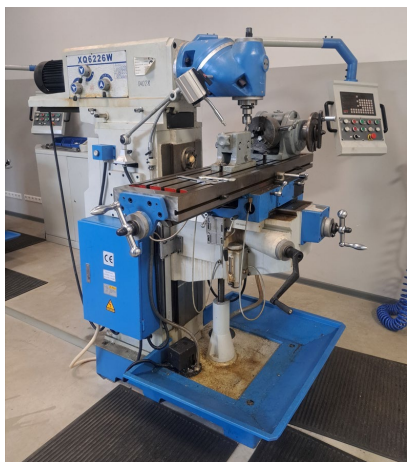
1 pav. Horizontalaus ir vertikalus frezavimo staklės QX6226W Šaltinis: sudaryta autoriaus
