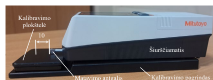
4 pav. Šiurkščiamatės Mitutoyo SJ-210 kalibravimas, vaizdas iš šono Šaltinis: sudaryta autoriaus
