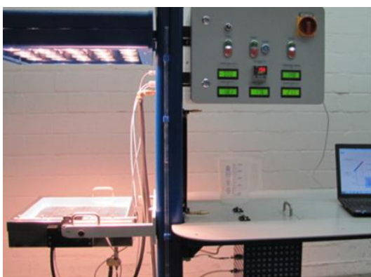
5 pav. Valdymo skydelis saulės kolektoriaus modulyje. Šaltinis: ET 202 Energy and Environment, GUNT Hamburg
